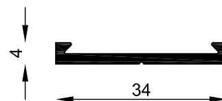
MT-2907 Tapajuntas puerta 44mm Peso estimado: 0.211 Kg/m Largo STD: 6150 mm
